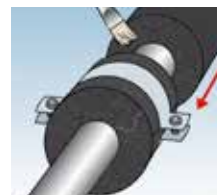
5 - Cole o suporte ao material de isolamento.
